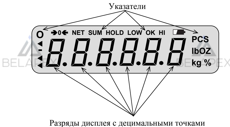
Рисунок 4.3 – Расположение указателей и разрядов дисплея
